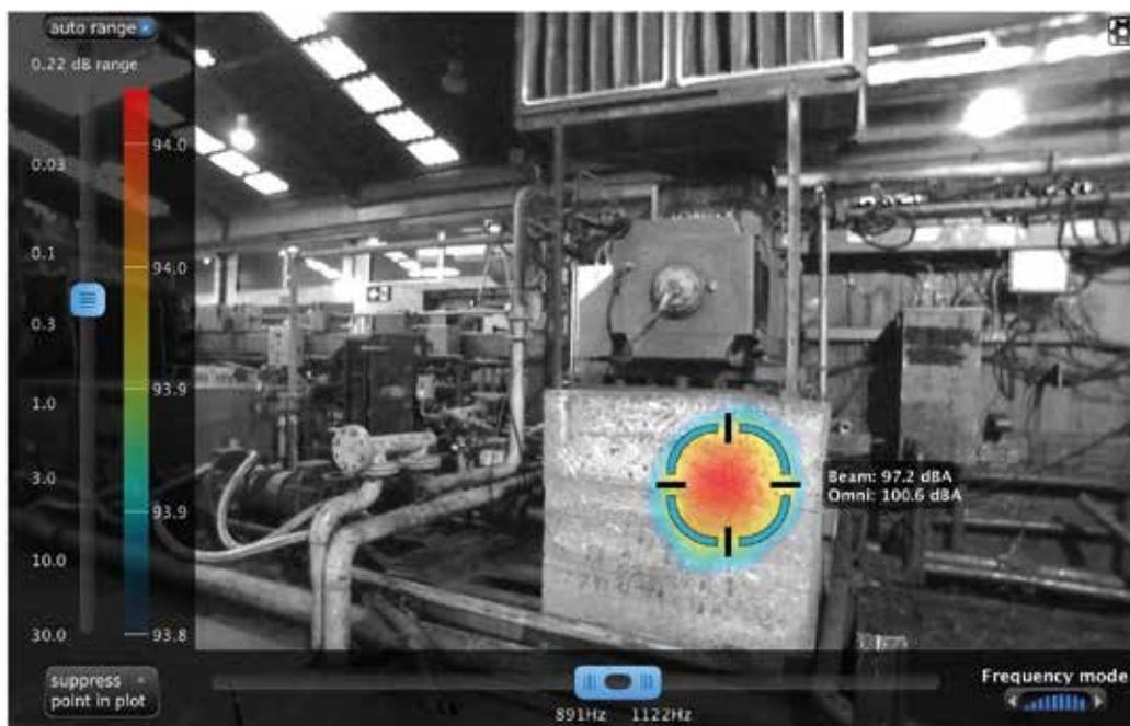
Esta imagen muestra en una situación real, con toda claridad, cómo las vibraciones que se transmiten desde el propio motor en el que se origina (en la parte superior) llegan incluso a la base inercial (una base de mucha masa que, justamente, se monta para controlar este tipo de efectos). Y es ésta la que finalmente es el foco de ruido que llega al trabajador.
