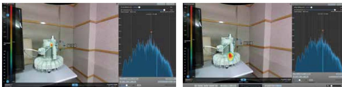
En las dos imágenes de la parte superior se muestran como diferentes partes del equipo emiten ruido en diferentes frecuencias. Existen diferentes tipos de tecnología aplicadas para construir motores eléctricos. Cada tecnología puede suponer diferentes focos de generación.
