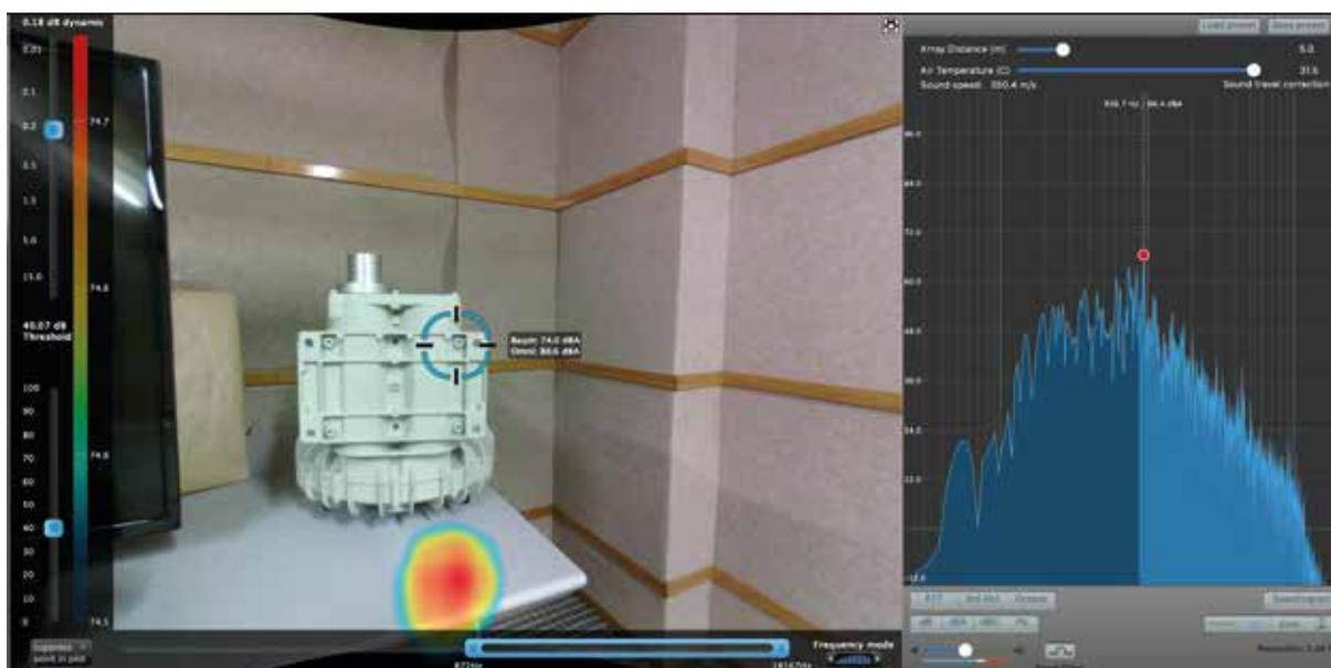
En el mismo régimen de funcionamiento, también se aprecia claramente cómo una superficie sobre la que se instala el motor se convierte por éste en una fuente de ruido.
