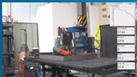
Soldadura sin extracción
