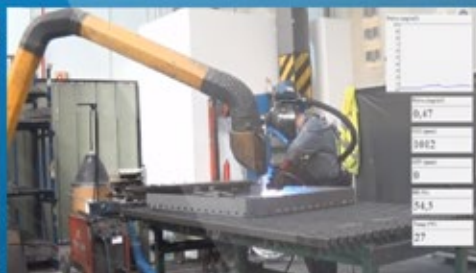
Soldadura con extracción
