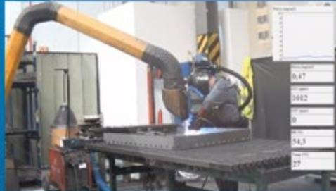
*Soldadura con extracción*
