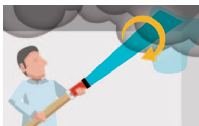
7. Si no puede verse el fuego, se arrojará también el chorro hacia el techo y las paredes con un movimiento giratorio, para alcanzar la mayor superficie posible y provocar un mayor enfriamiento del recinto.
