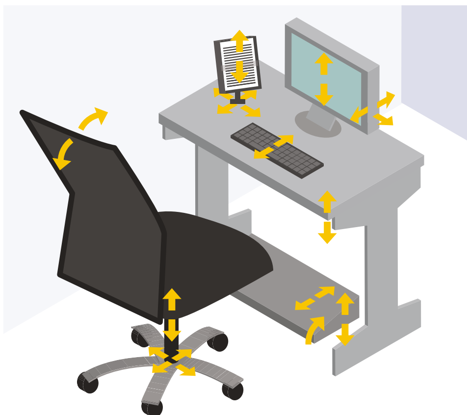
Posibilidades de regulación de los diferentes elementos de un puesto de trabajo con pantalla.
