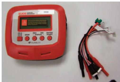
Si hay balanceo significa que aparecen diferencias de tensión entre las distintas celdas de una misma batería. **Si alguna de las celdas llega al límite de 3.3 v las celdas empezarán a fallar.**
