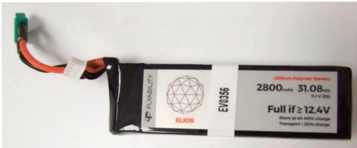
**Número de celdas «S»:** Podríamos decir que una batería es una sucesión de pilas. A estas pilas las llamaremos celdas. Las baterías llevan escrita la palabra celda o una S. Por ejemplo, una batería 4S (4 celdas) estaría compuesta, por tanto, de 4 sub-baterías conectadas en serie.
