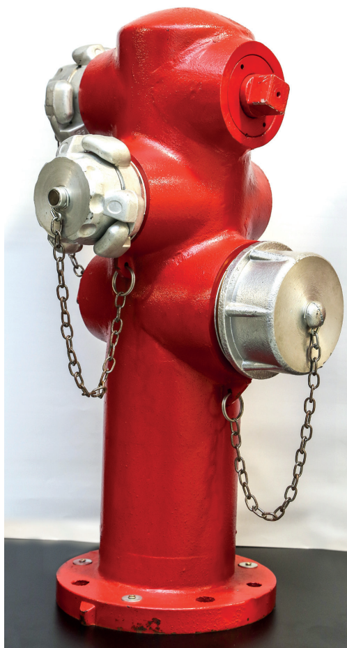
Hidrante de columna humida de 100 mm amb dues sortides de 70 mm i presa d'aigua de 100 mm per als bombers
