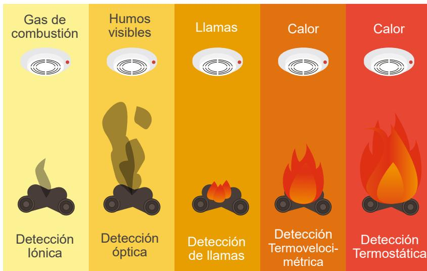
Los detectores de incendios están diseñados usualmente para detectar una o más de las tres características del fuego: el humo, el calor y la radiación (llama). Cada tipo de detector corresponde a los distintos tipos de fuego con una sensibilidad diferente. Existen también detectores multisensores que combinan la detección simultánea de varias magnitudes, por ejemplo temperatura, humo y gases de combustión como el CO (monóxido de carbono).
