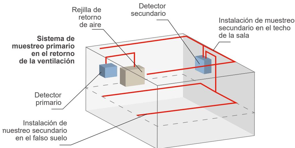
En los Sistemas de Detección por Aspiración son de suma importancia todas las conducciones de tuberías, para obtener una constante y eficaz corriente de aire en todo el circuito, para así permitir la más alta sensibilidad de los detectores. El aire de las zonas a analizar es canalizado hacia el detector que analiza la concentración de humo en cada instante.
