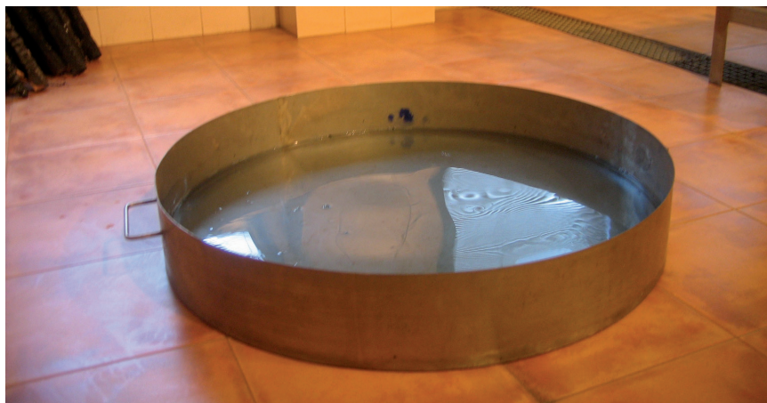
Fotografia d'un fogar tipus 55 B (1480 mm diàmetre x 150 profunditat – superfície 1,73 \text{ m}^2 )
