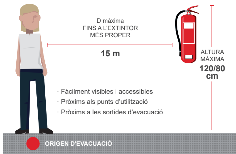
Figura 1 - Situación i emplazamiento de los extintores
