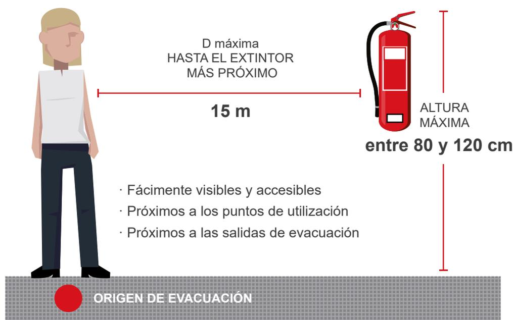
*Figura 1 - Situación y emplazamiento de los extintores*
