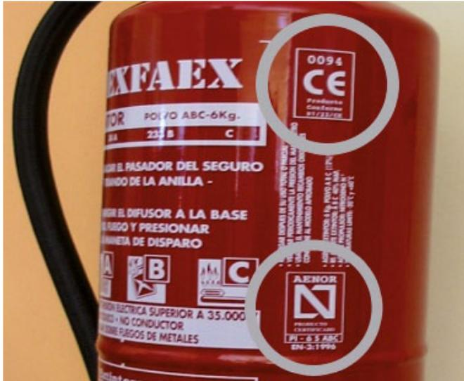
Esta placa ha sido sustituida por el marcado CE, que será simultáneo con el marcado N o equivalente. La marca CE garantiza que el extintor ha sido fabricado según lo exigido por el Reglamento de Equipos a Presión, mientras que la marca N se refiere al cumplimiento de lo establecido para la marca de conformidad a normas del Reglamento de Instalaciones de Protección Contra Incendios (RIPCI), y en concreto, para los extintores, que cumplen las exigencias de la Norma UNE EN 3-7:2004+A1:2008.
