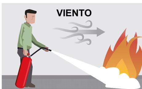
5. Presione la palanca de descarga para comprobar que funciona el extintor.
