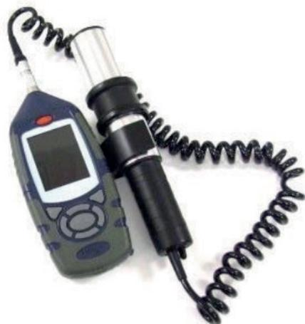
• Monitor de calidad de aire de interiores Q-Track 7575, con el que se pueden monitorizar CO<sub>2</sub> (0-5.000ppm), Temperatura, Humedad Relativa, Compuestos Orgánicos Volátiles (1-2.000 ppm).
