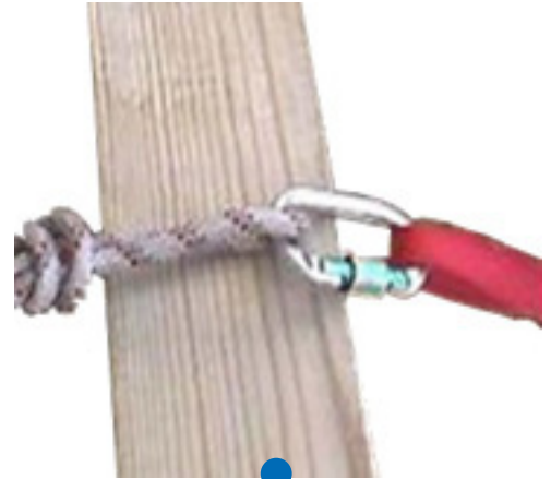
Posición peligrosa trabajo en palanca.
